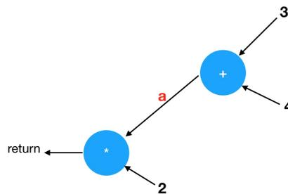
我故意把箭头方向画成从右往左，这样它就更像上面的代码。从这个图画里，你也许可以看到变量  $a$  和风扇控制器图里的参数  $t$ ，其实没有任何本质差别。它们都表示一根电线，那根电线进入乘法器，将会被乘以  $2$ ，然后输出。如果你把这些都看成是电路，那么变量  $a$  和参数  $t$  都代表一根电线而已。
