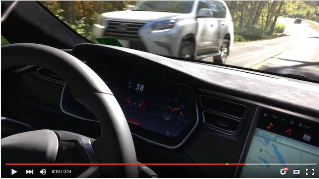
特别是[视频1](#)显示，在路面线条清晰，天气很好的路上，autopilot 忽然向左，试图转向反方向的车道，差点导致严重的对撞车祸。仔细观察 autopilot 转向之前的情况，是由于路面上有阳光投下来的树影。Autopilot 误以为那是一个障碍物，所以试图把车转上反方向的车道！
